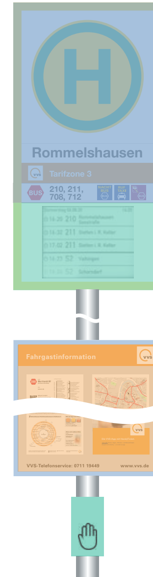
Haltestellenmast mit Haltestellenschild und DFI-Light-Modul mit optionalem TTS-Taster für Vorlesefunktion (Text to Speech)
